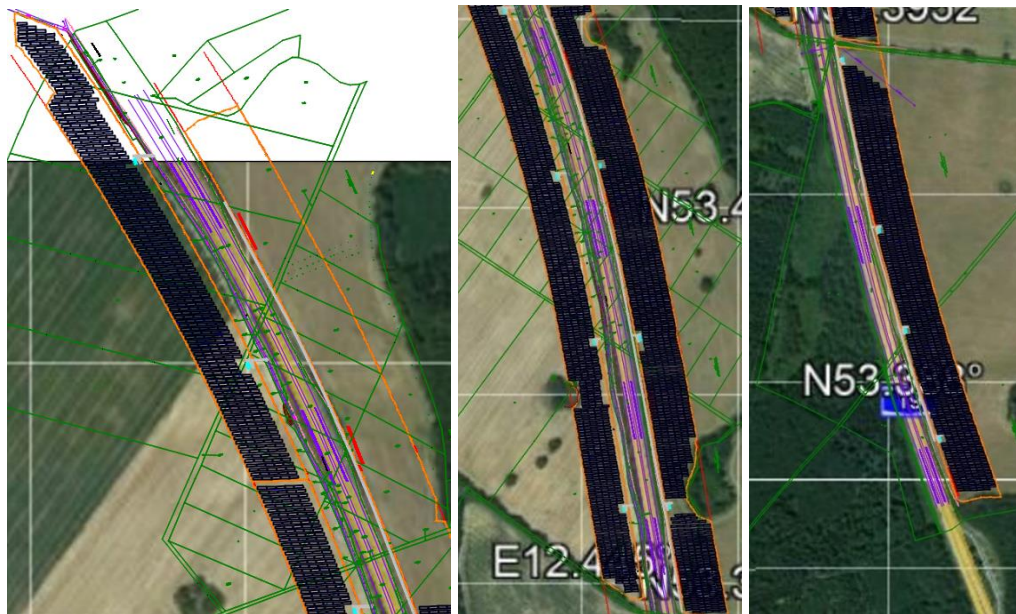
Abbildung 5: Lage der Modultischreihen (schwarz) an Google Earth angepasst anhand des Autobahnverlaufs; links: nördlicher Anlagenteil; Mitte: mittlerer Anlagenbereich mit Modulreihen beidseits der Autobahn; rechts: südlicher Anlagenteil
