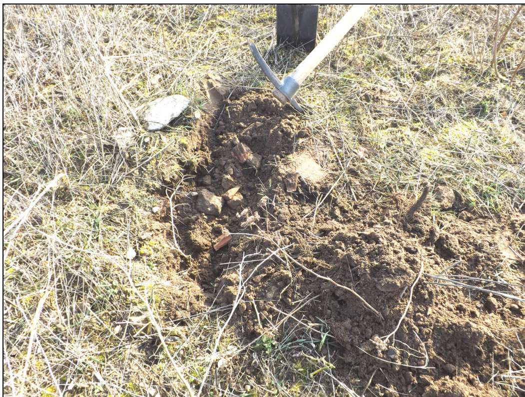
Abbildung 1.18-3 mit Ziegelmauerwerksbruch durchsetztes Erdreich
